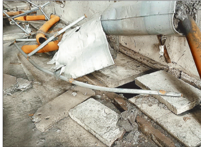
हादसे के बाद मौके पर क्षत-विक्षत अवस्था में पड़ा बायलर पाइप का हिस्सा।
